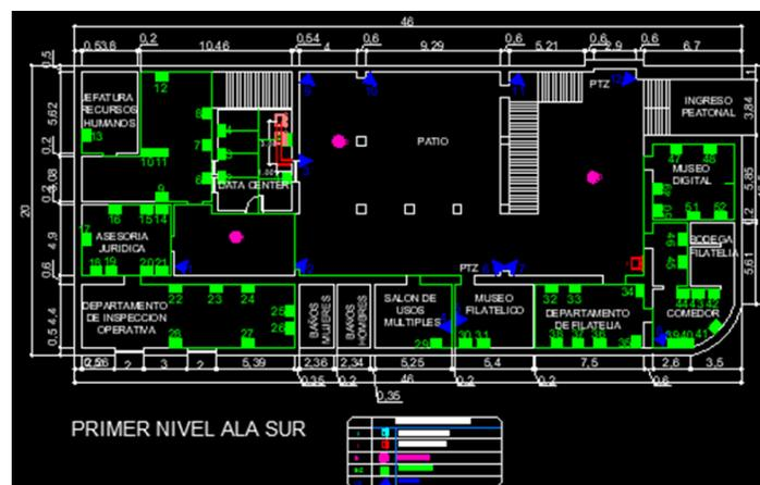
Plano de Planta - Detalle de Puntos de Red – DGCT
